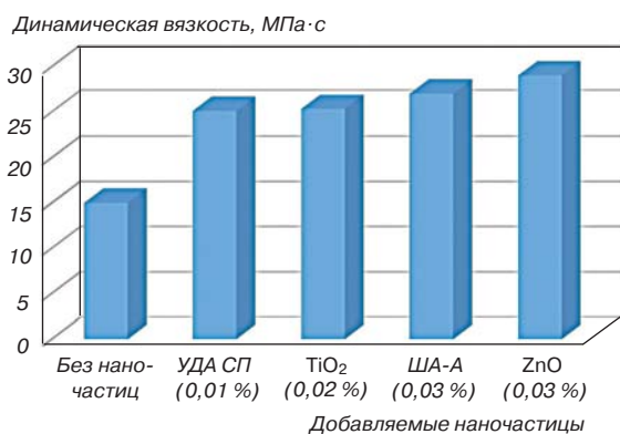
Рис. 2. Зависимость динамической вязкости от добавляемых наночастиц
