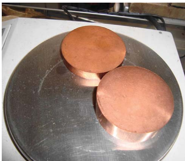
Таблетки лигатуры наномодификатора
