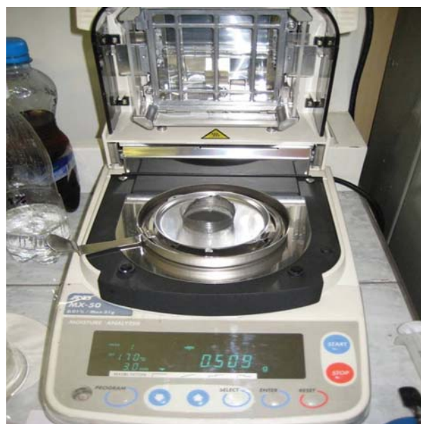
Анализатор влажности AND MX-50
