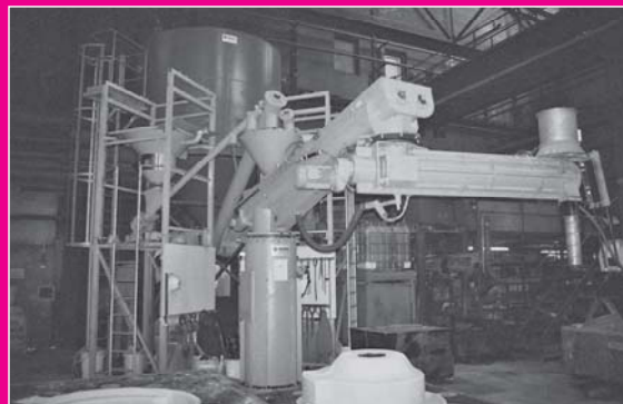
Трёхвальный смеситель непрерывного действия со двояной подачей присадок
