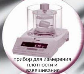
прибор для измерения плотности и взвешивания
