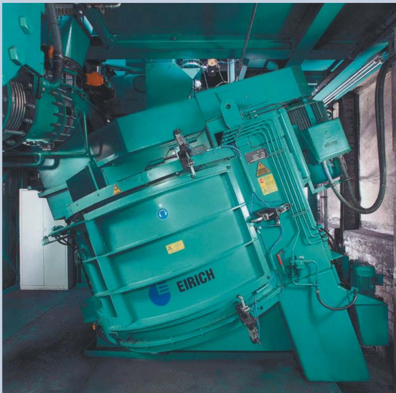
Миксер EVACTHERM полезным объемом 3000 л
