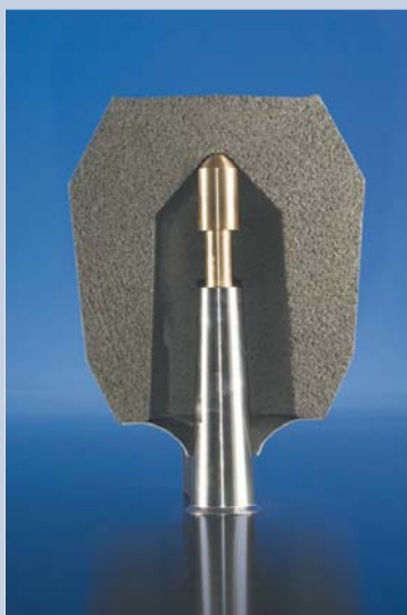
Поперечное сечение питающей прибыли PX-ME N с пружинным штифтом
