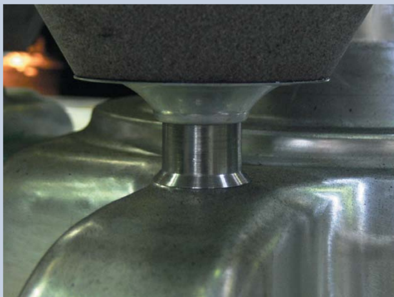
Питающая прибыль на пружинном штифте, удерживаемая над плитой модели перед заполнением формы
