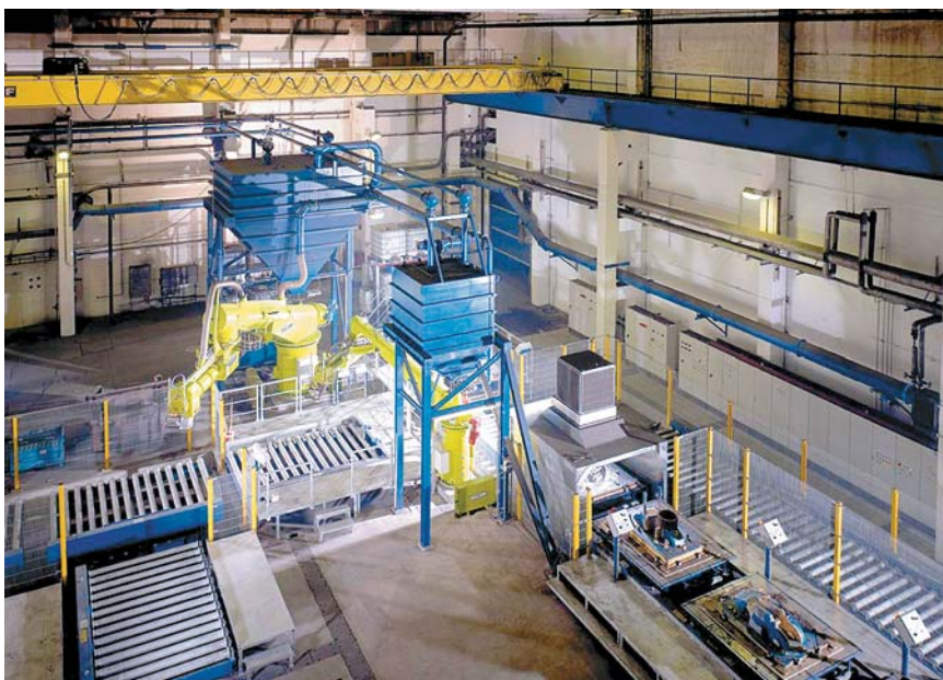
Рисунок 1. Формовочная установка, использующая Альфа-сет-процесс
