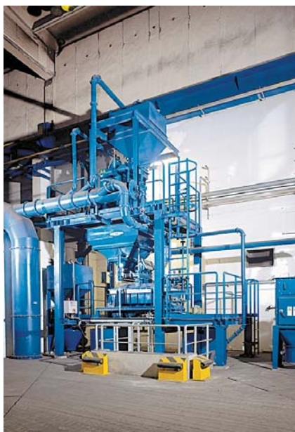
Рисунок 4. Система сепарации хроморудной смеси
