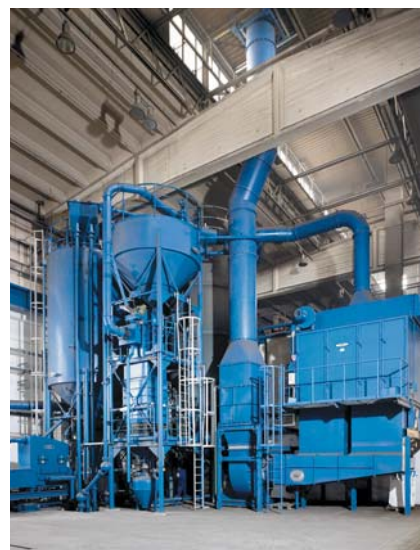
Рисунок 2. Установка регенерации формовочного материала по Альфа-сет-процессу
