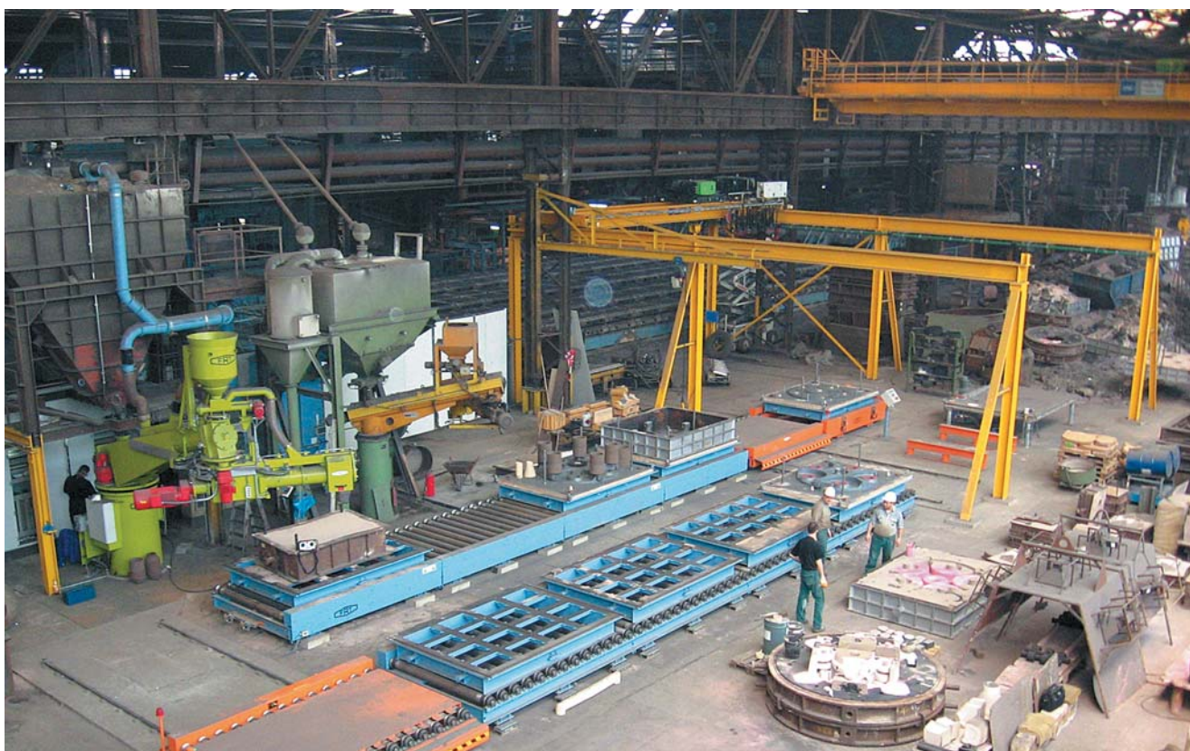
Рисунок 3. Установка формования опок для крупногабаритных отливок на основе использования Альфа-сет-процесса
