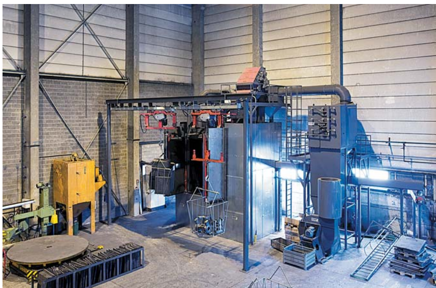
Рисунок 4. Подвесная монорельсовая машина дробеструйной очистки RHBE 20/25, управляемая через программируемые логические контроллеры, имеет программы обработки, конкретизированные для различных отливок с точки зрения продолжительности обработки и интенсивности обдувки. Полностью закрытый кожухом износостойкий вибрационный транспортер возвращает смесь дробы и формовочного песка в интегральный цикл утилизации рабочей среды
