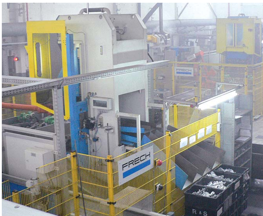
Рисунок 5. Автоматическая сортировка право- и левосторонних деталей
