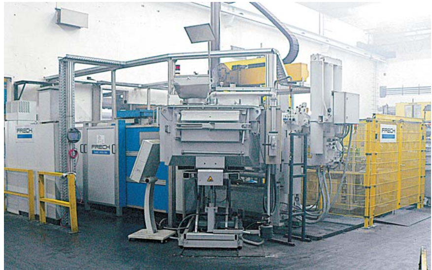
Рисунок 2. Литейная машина DAK 450-54 с номинальным усилием запирания пресс-формы 5000 кН
