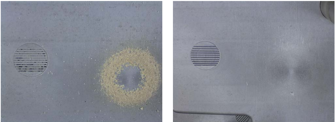
Рисунок 1. Загрязненные щели форсунки в устройстве для очистки стержневого инструмента (слева) и то же устройство после очистки водой высокого давления
