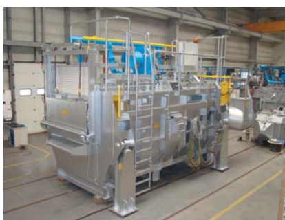
Новая печь StrikoWestofen типа HR-T 10.000/500 с плавильной рампой и гидравлическими опрокидывателями
