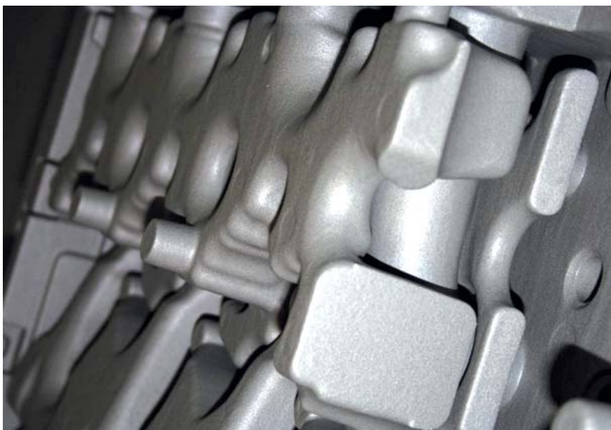
Стержни для отливки головок цилиндров с покрытием MIRATEC TS
