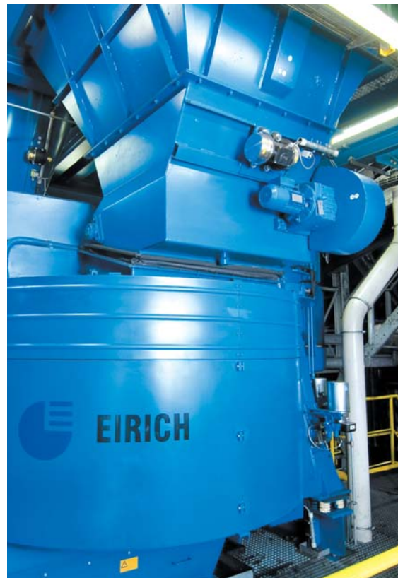
Рисунок 3. Новый мощный миксер, базовый элемент системы подготовки смеси, существенно повышает производительность линии литейного производства компании Olsberg Hermann Everken GmbH
