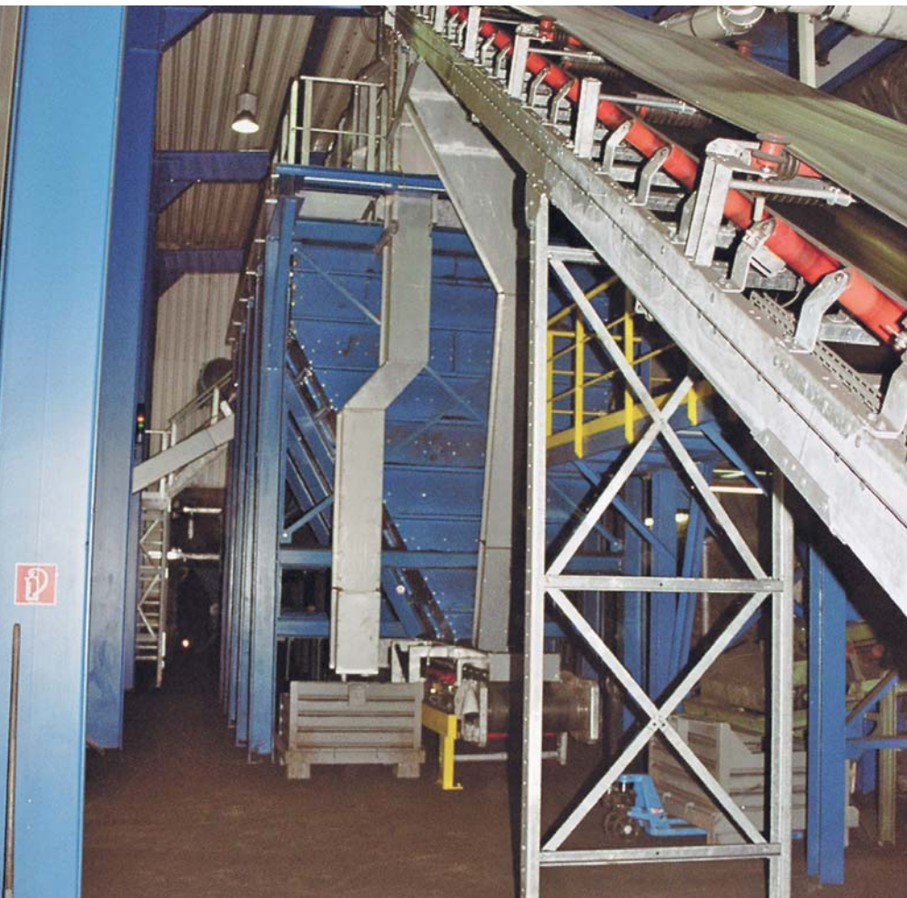
Рисунок 2. Отделение и удаление некондиционных фракций смеси с помощью нового полигонального сита
