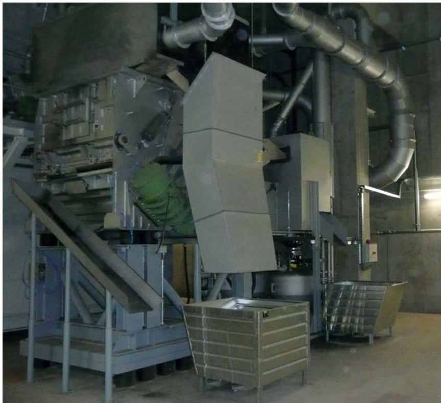
Рисунок 2. Выбивная и дробильная установка с двумя вибрационными измельчителями кусков (производительность 2х25 т/ч)
