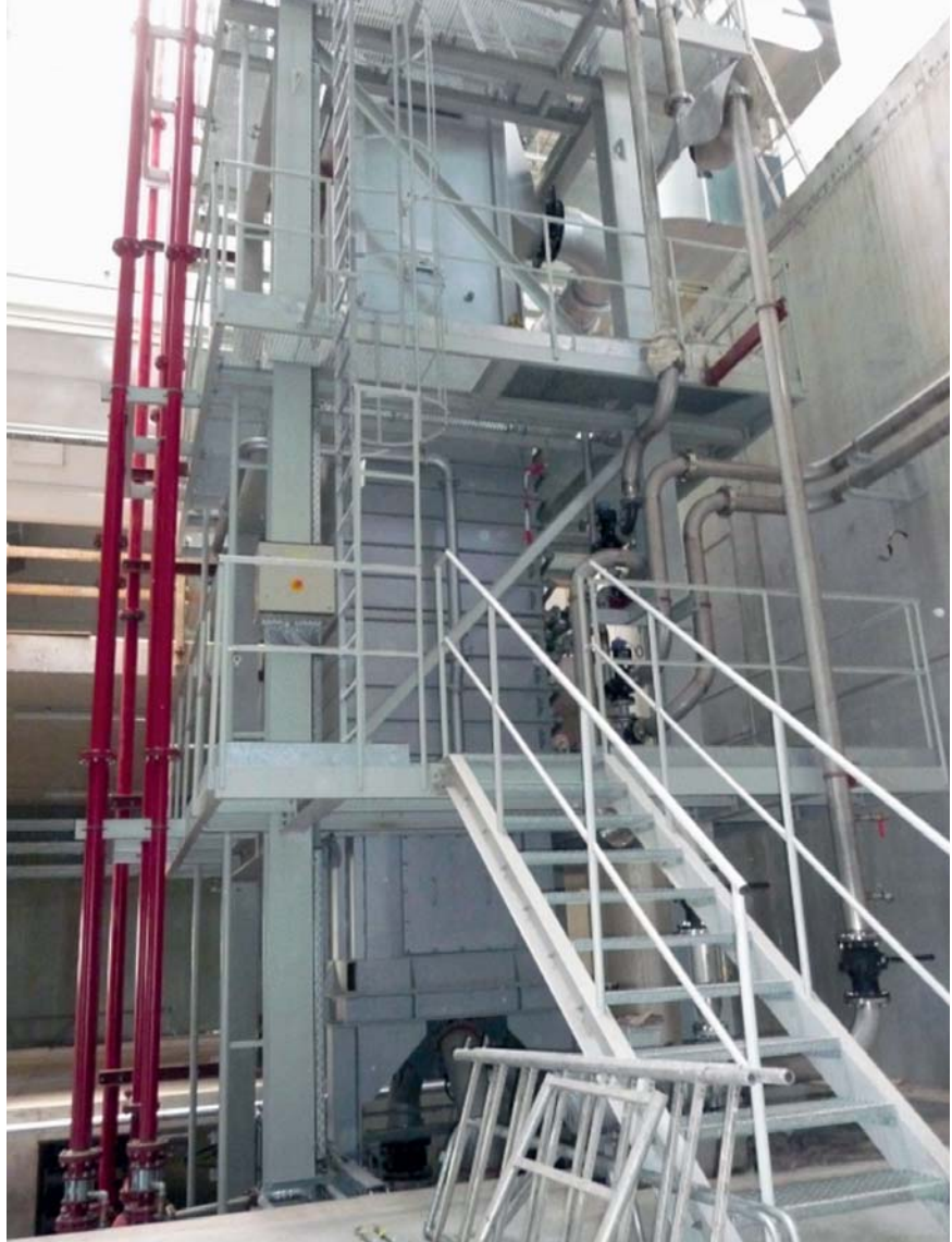
Рисунок 1. Система регенерации формовочной смеси компании F.A.T. с просеивающей машиной и дефлегматором (производительность 50 т/ч)
