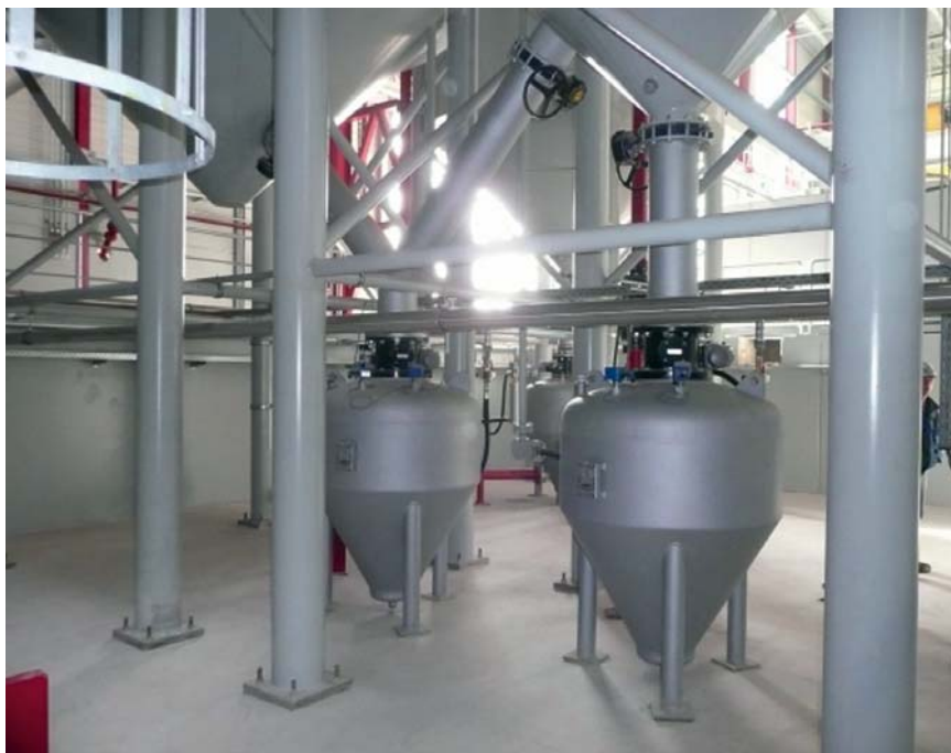
Рисунок 3. Подача смеси пневмотранспортерами перекрестного типа компании FAT
