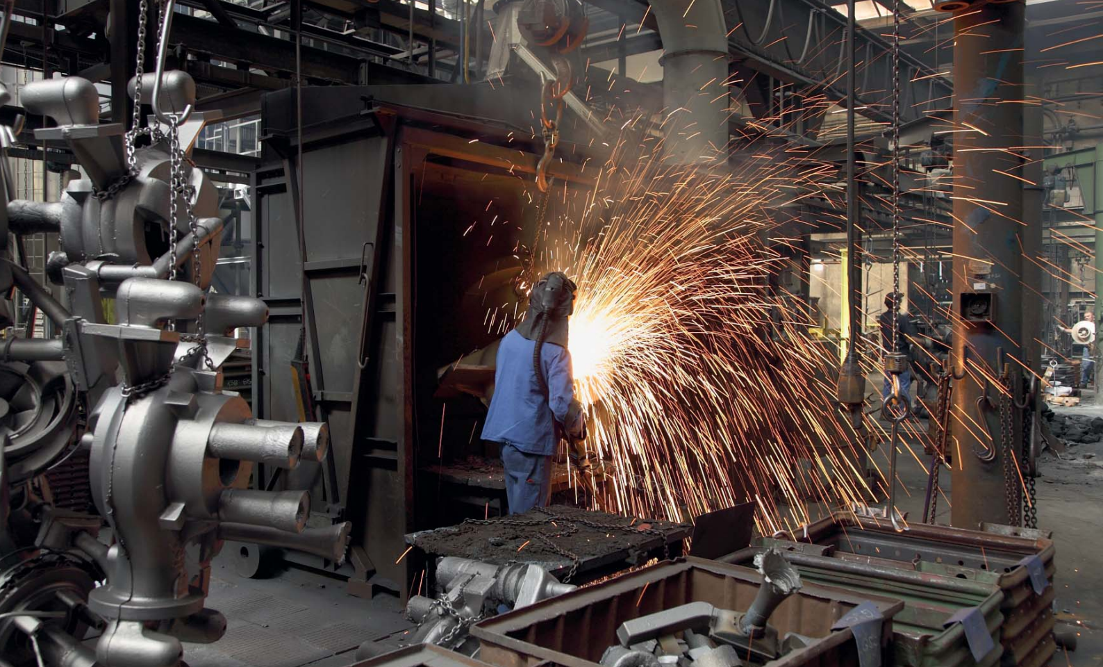
Финишная обработка отливок на литейном производстве Pegnitz Foundry компании KSB
