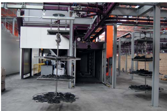
Новая двухкамерная машина абразивной очистки отливок
