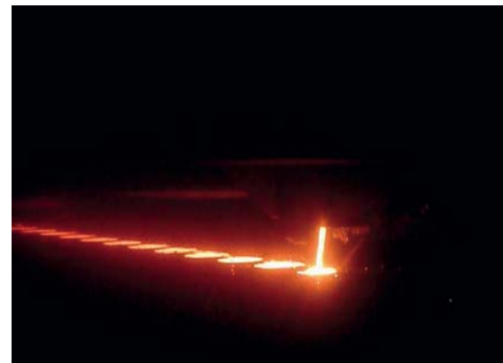
Рисунок 11. Заполнение формы с использованием системы OptiPour на основе лазера на литейном предприятии Franken Guss GmbH, Китцинген (Германия); безопасная формовочная машина производительностью 540 форм/ч [2]
