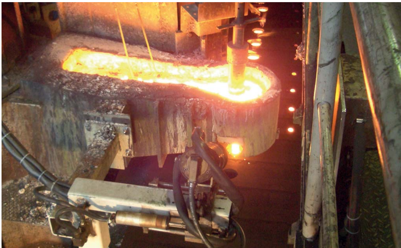
Система OptiPour с оптической камерой, применяемая на предприятии Miele, Гютерсло, Германия (фото: АВР)
