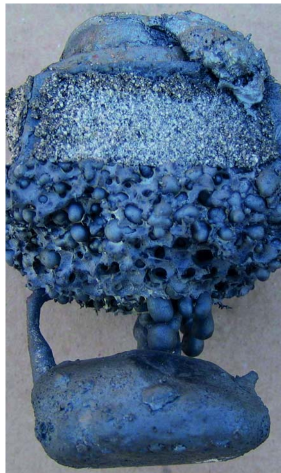
Рисунок 2. Закупоренный горизонтальный фильтр 50x50x20/10 ppi
