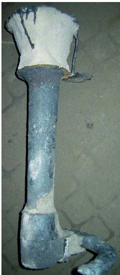
Рисунок 1. Закупоренный вертикальный фильтр 50x50x20/10 ppi
