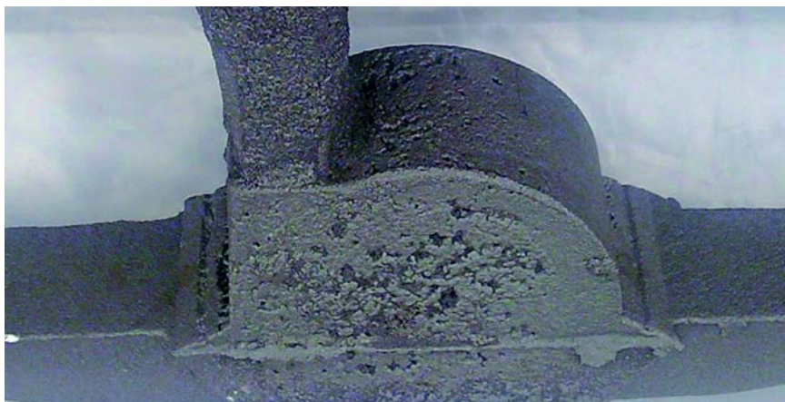
Рисунок 8. Поверхность выпускного желоба после фильтрации Turboprint
