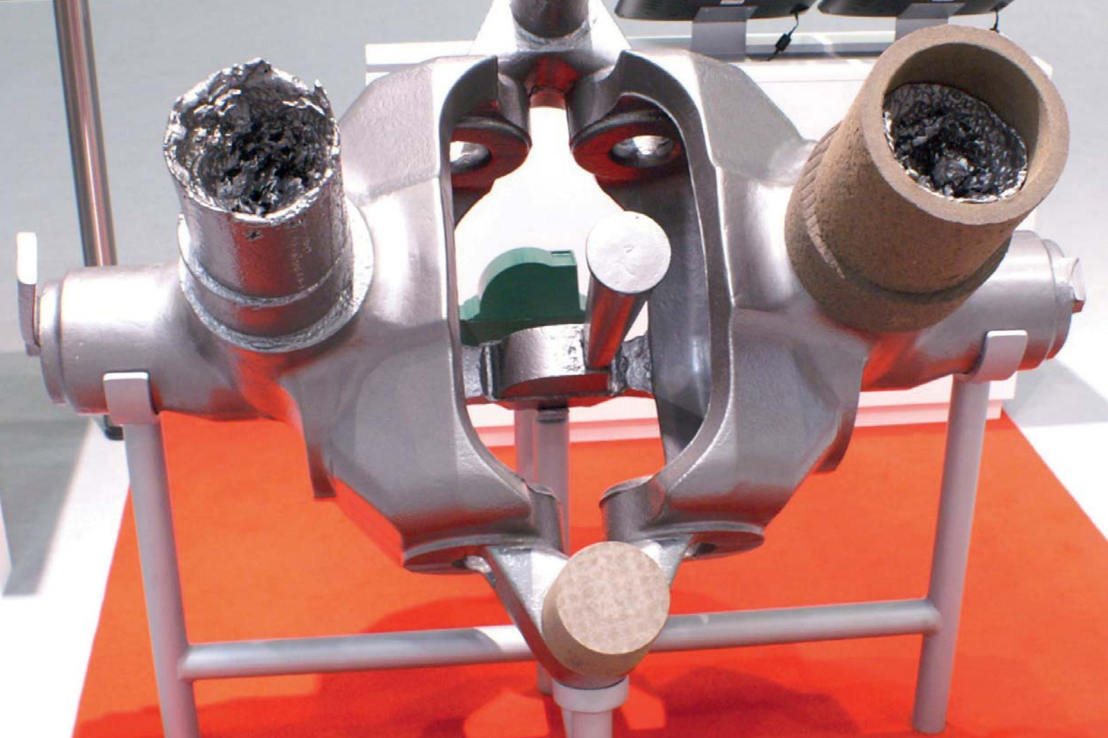
Две отливки, полученные с использованием узлов Turboprint и Kalmineх. Выход металла увеличился (фото Foseco)
