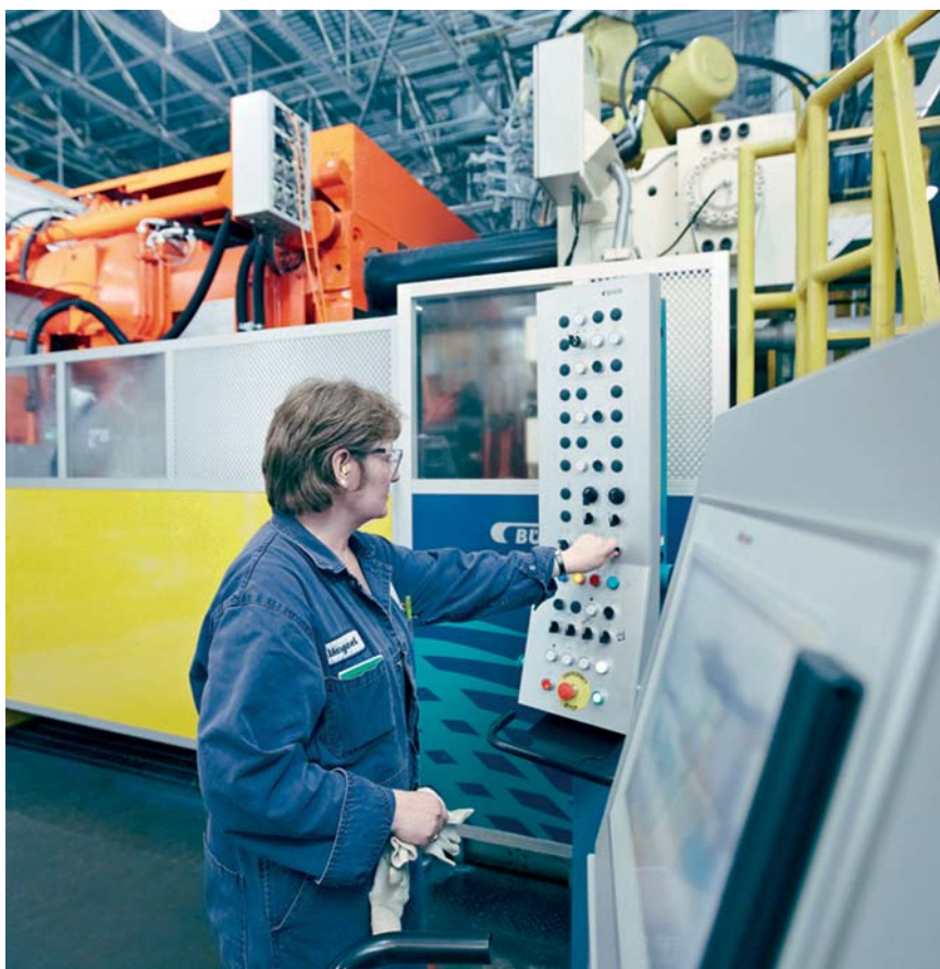
Маргарет Шарплес и Кен Чан изготавливают поперечные подвески на литейном предприятии Etobicoke Casting Plant компании Chrysler
