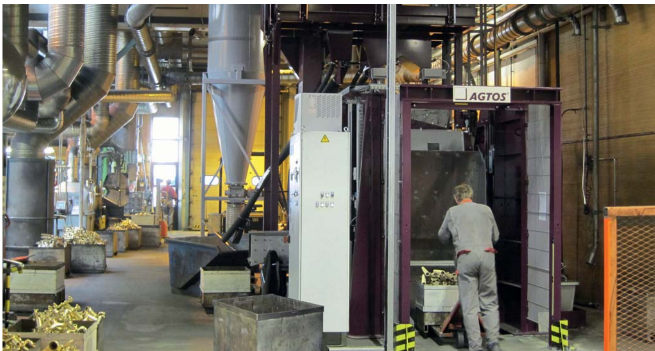
Загрузочная сторона дробеструйной машины со стальным ленточным транспортером во время загрузки (фото: AGTOS)
