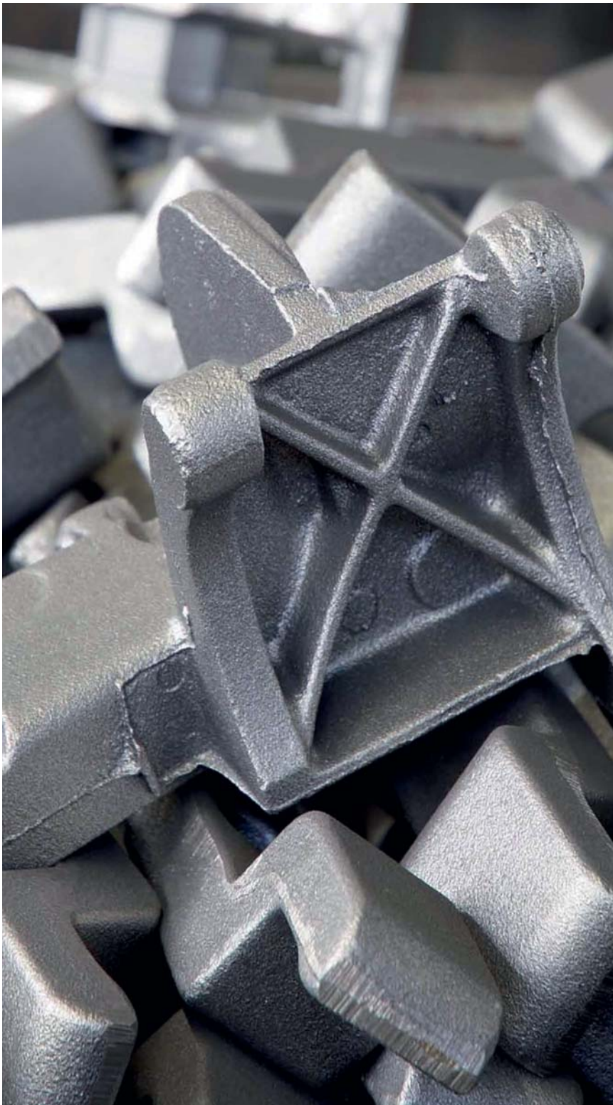
Рисунок 1. Поверхность деталей после дробеструйной очистки
