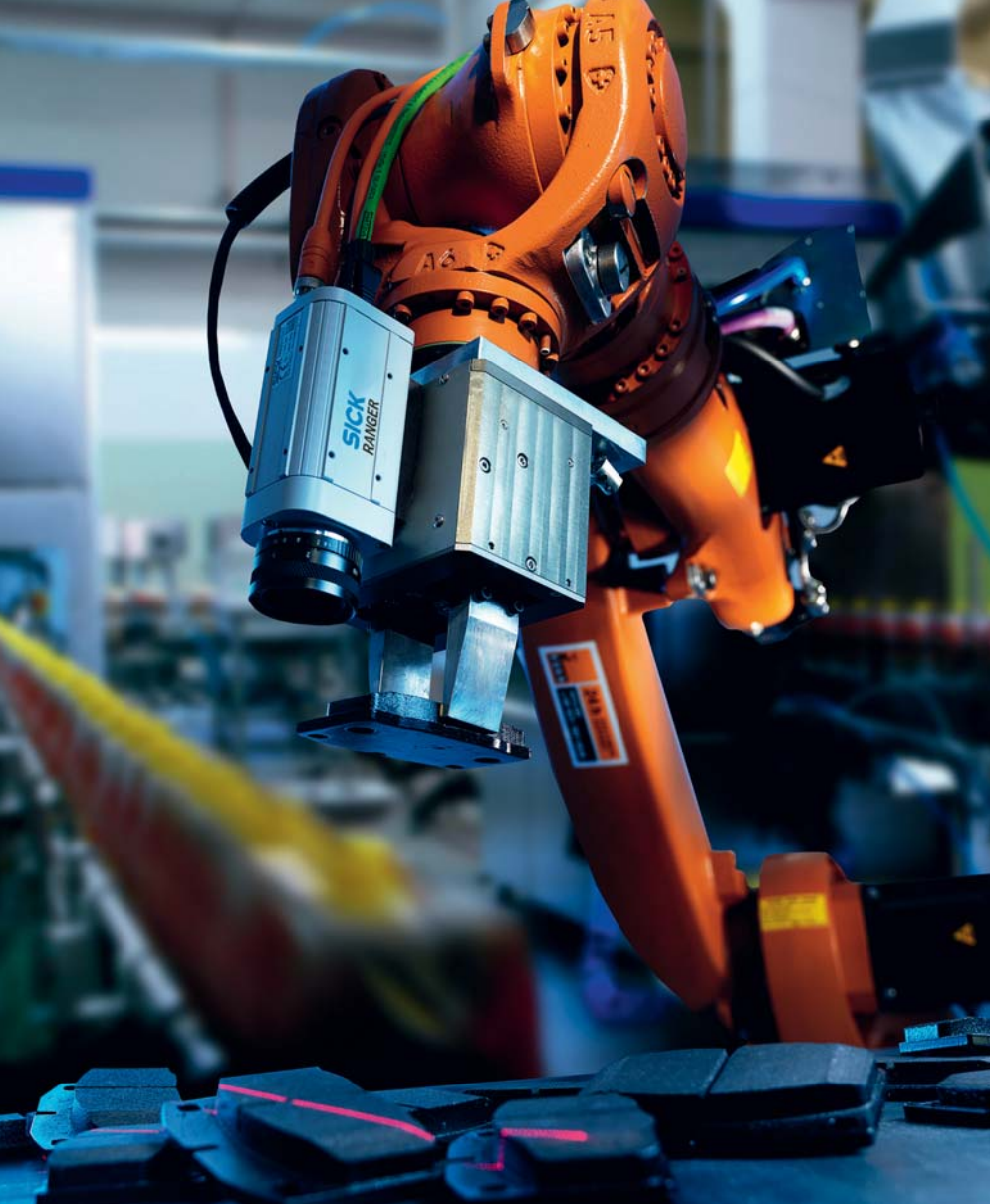
Трехмерный сканер, определяющий самую сложную форму детали и координаты пути перемещения робота
