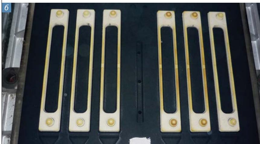
Рисунок 1. Литейные опоки для производства нагревательных сегментов (радиаторов) без стержней (а) и с установленными стержнями (б)
