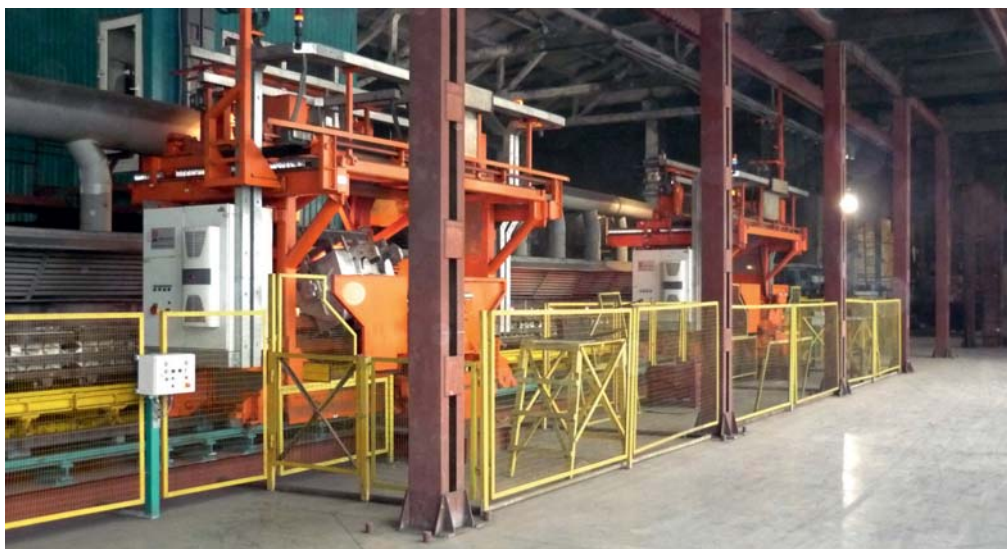
Рисунок 2. Два заливочных автомата типа Р-10-С, установленных на ЛЛМЗ
