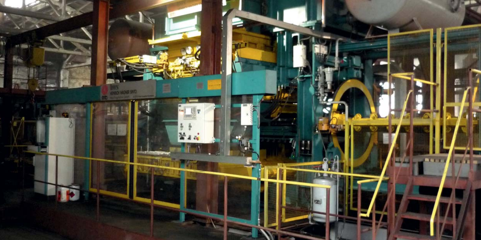
Формовочная линия по Сейатцу-процессу; формовочный автомат с воздушным обдувом типа ZFA-SD 5
