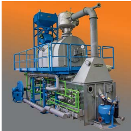
Компактная термическая регенерационная установка после предварительной сборки перед отправкой заказчику
