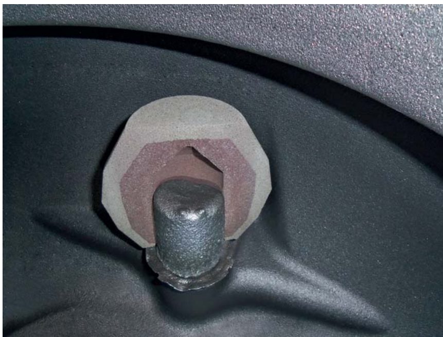
Рисунок 5. Размещение ЕСО-прибыли непосредственно на профилем контуре отливки
