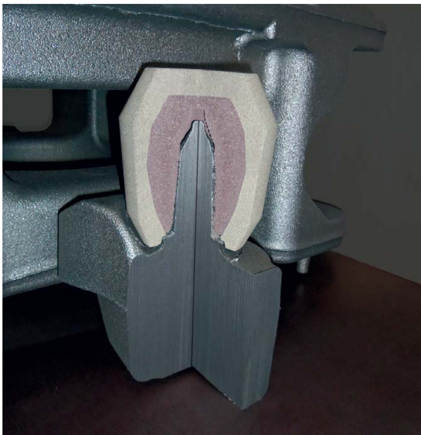
Размещение оптимизированной по размерам ЕСО-прибыли в стержне с тонкими внешними стенками
