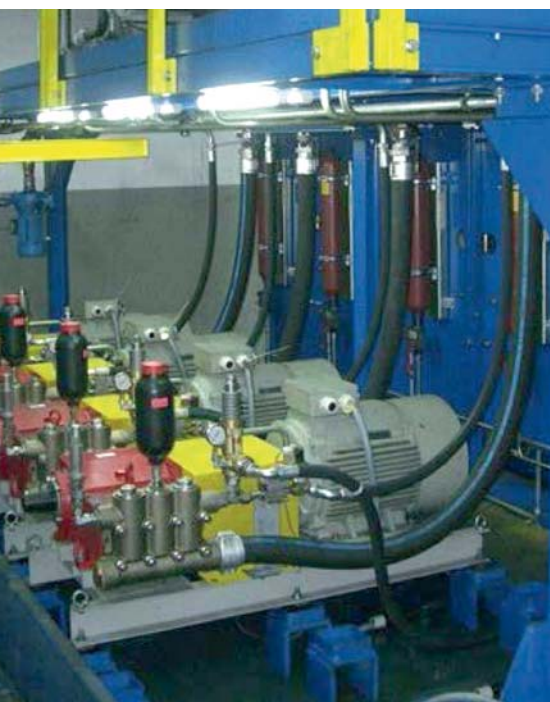
Рисунок 4. Водяная гидравлическая система качания печей канального типа на предприятии компании Georg Fischer в Меттмане
