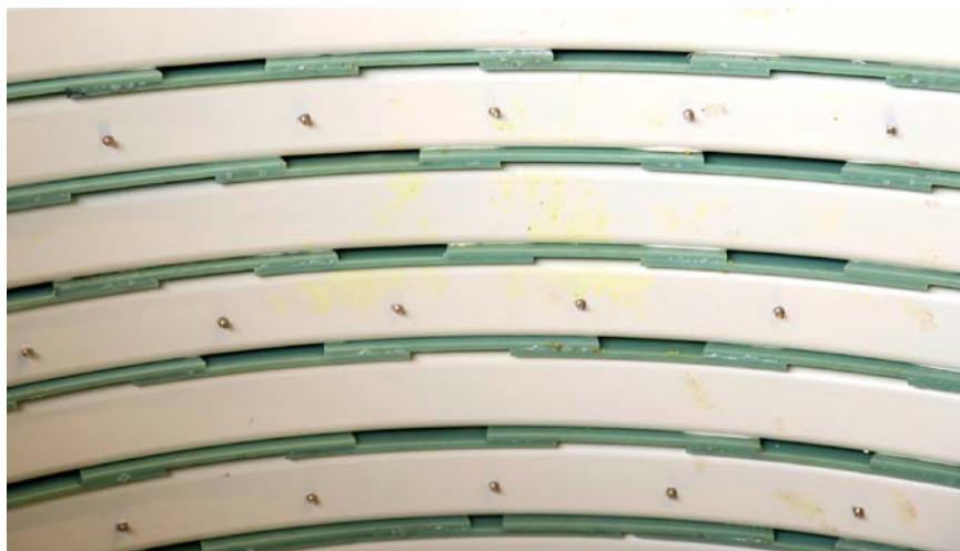
Рисунок 8. Вид высокоэффективной катушки с подробным изображением сегментов между витками
