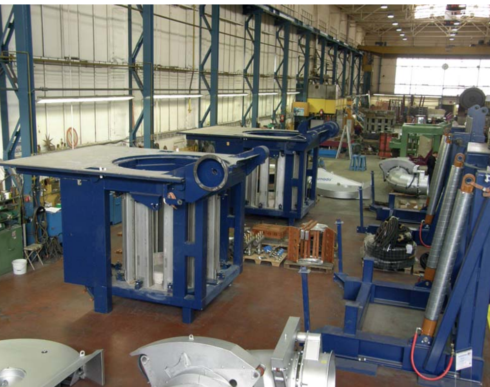
Производство тигельных индукционных печей на предприятии компании ABP (Дортмунд, Германия)
