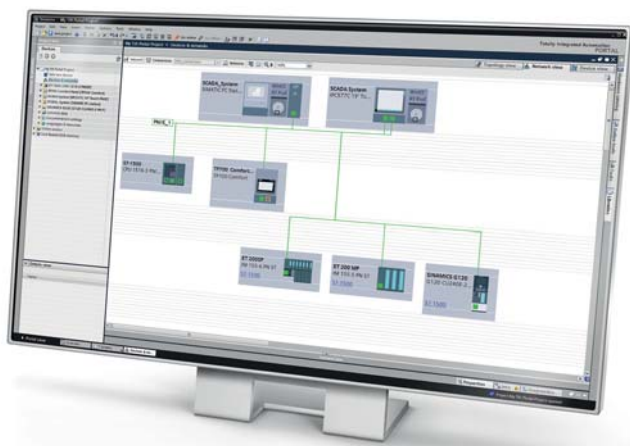
Рисунок 2. Интуитивная инженеринговая платформа на основе портала ТИА предоставляет поддержку для графического формирования конфигурации, программирования и объединения в сеть постоянно растущего числа компонентов. Специалисты компании Reis Robotics убеждены, что это позволяет сократить на 30 % расходы, связанные с инженерингом
