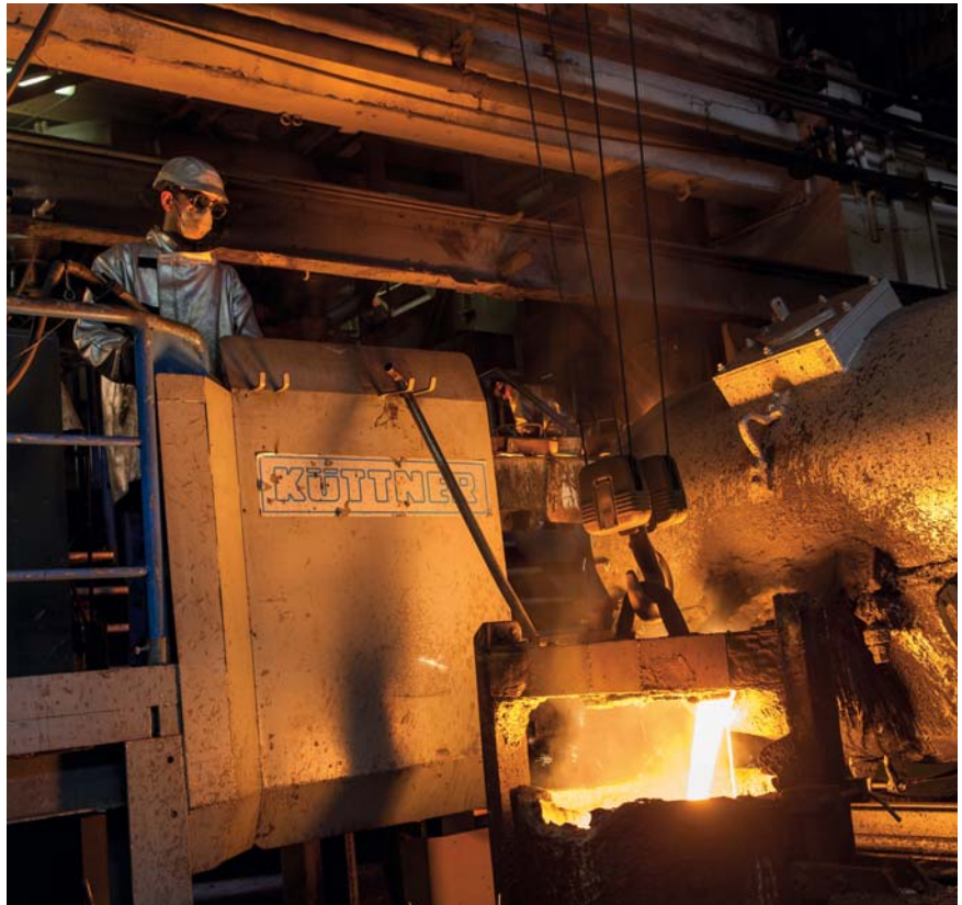
Транспортирование жидкого чугуна: с помощью крана, обслуживающего этот пролет, ковши постоянно курсируют между вагранкой и печью-миксером
