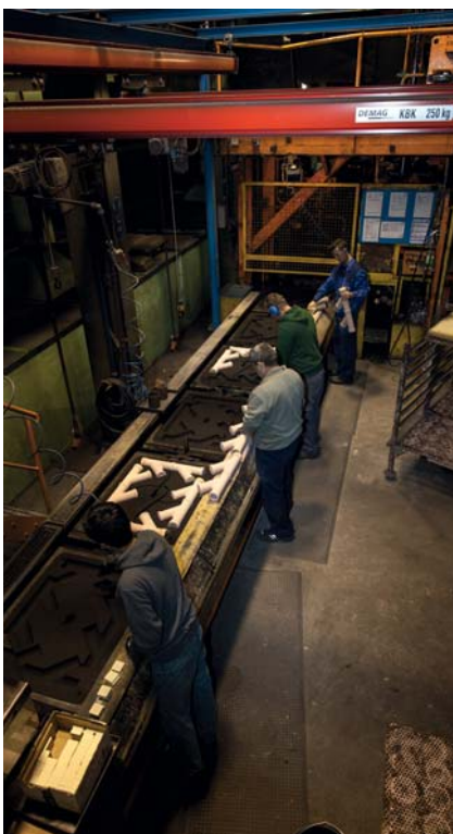
Литейный цех на заводе компании Düker в Карлштадте. Здесь производят фитинги и соединительные детали для дренажных систем
