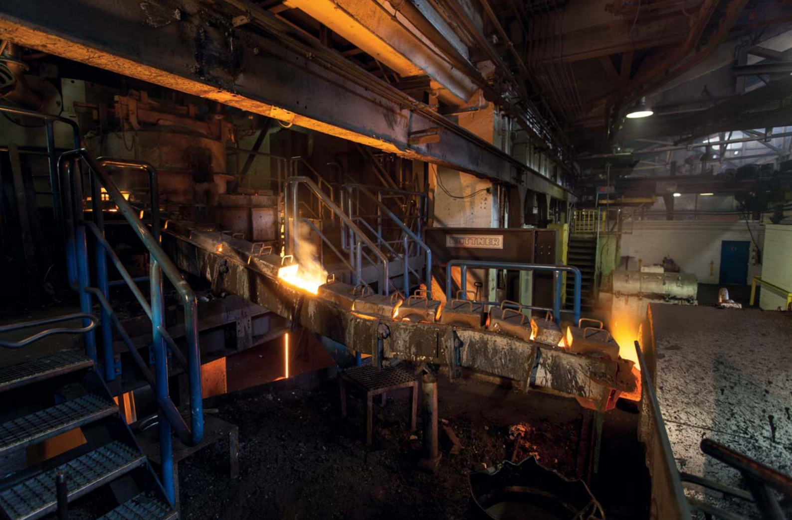
Жидкий чугун выпускают из плавильного агрегата при температуре порядка 1500 °С по теплоизолированному желобу
