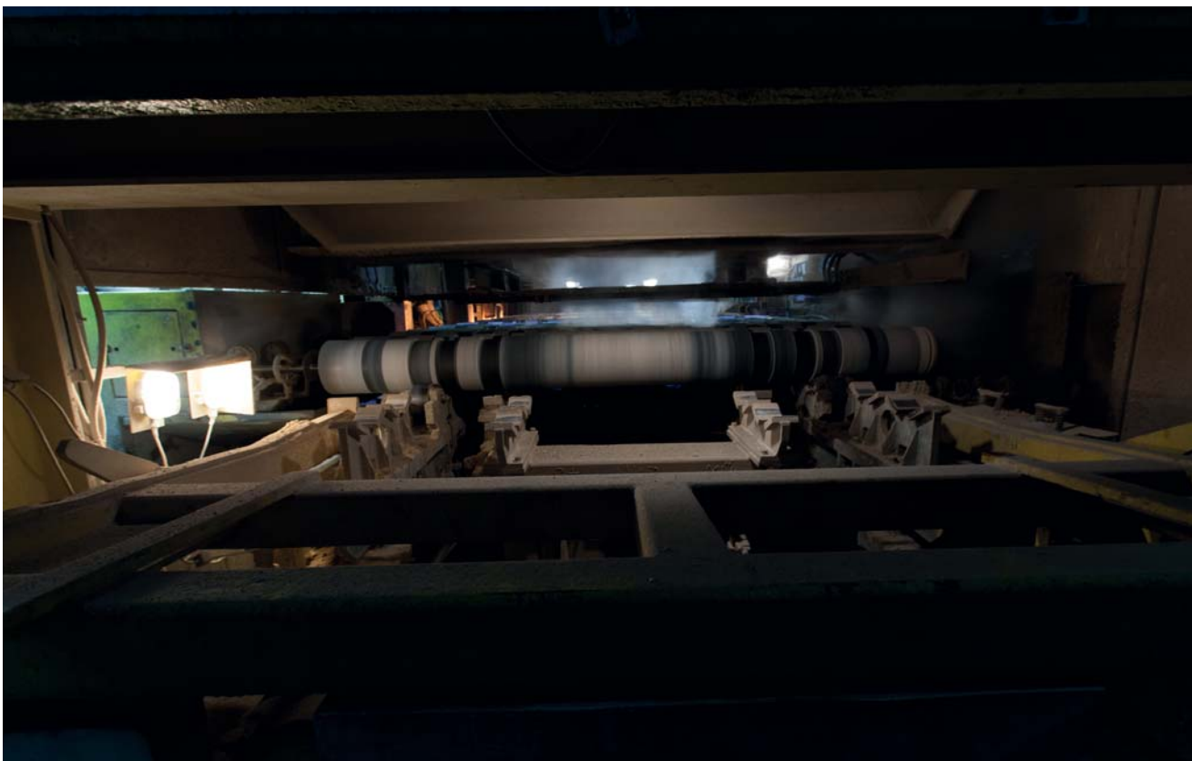
Вращающиеся охлаждаемые литейные формы на установке центробежного литья
