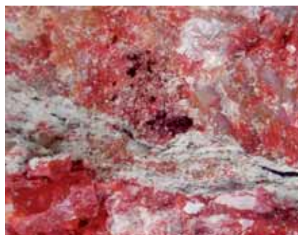
Рис. 4. Трещины усушки глинистых слоев на стенке горной выработки — потенциальные рассолопроводники
