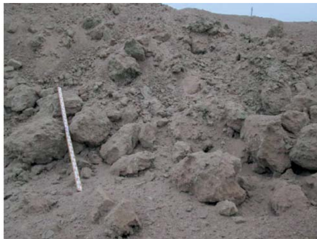
Рис. 4. Развалы взорванной горной массы на первом (базовом) (а) и втором (исследуемом) (б) участках опытно-промышленного блока
