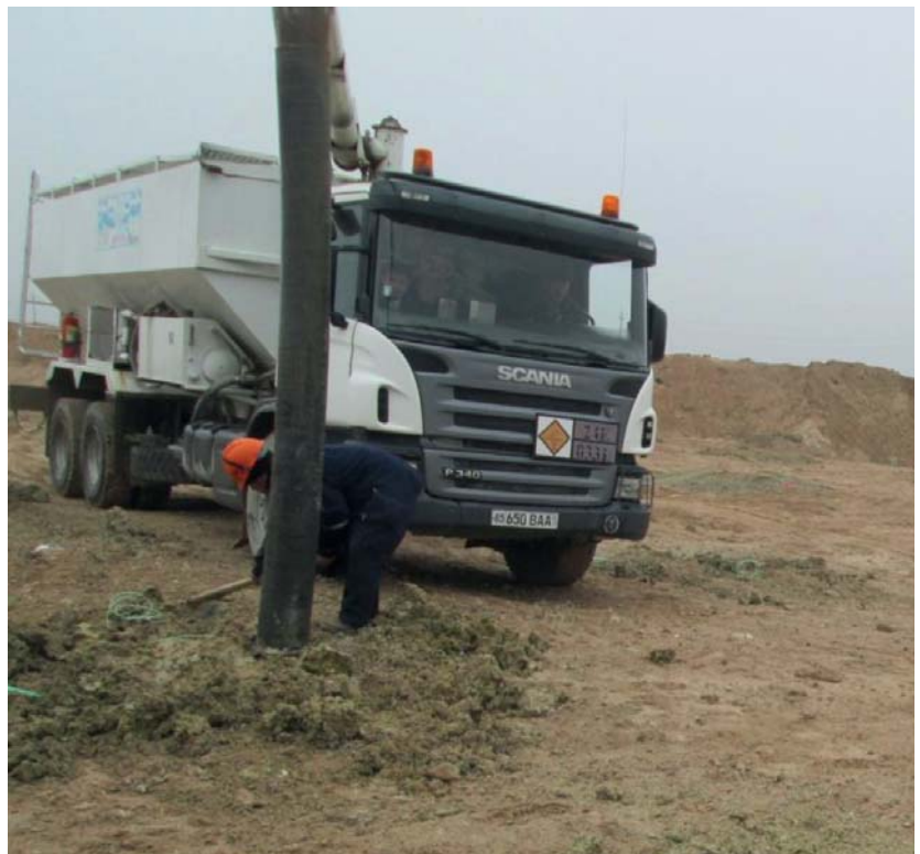
Рис. 3. Общий вид рабочей площадки опытно-промышленного блока (а), конусная металлическая воронка для формирования кумулятивной полости в донной части заряда ВВ (б), зарядание скважин на блоке (в)
