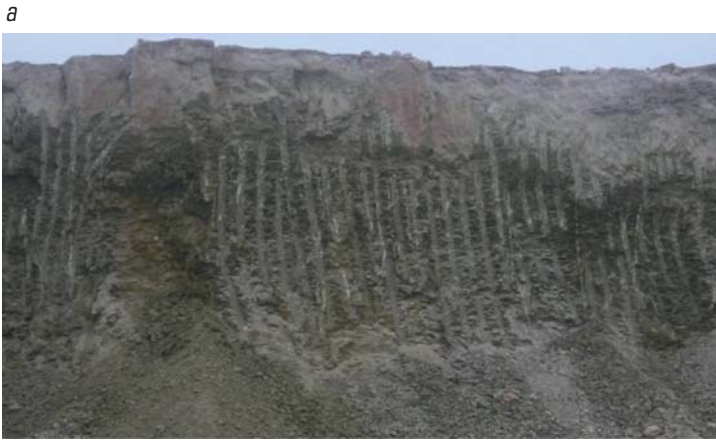
Рис. 2. Общий вид откоса уступа (а) и структура разнопрочного массива (б) опытно-промышленного блока в карьере «Ташкура»: 1 — полускальный слой известковистого мергеля (средняя мощность m = 1 м, коэффициент крепости по М. М. Протодяконову f = 5 ); 2 — плотный глинистый мергель / конгломерат ( m = 3 м, f = 4\div 5 ); 3 — плотная бентонитовая глина ( m = 3\div 5 м, f = 3\div 4 ); 4 — пластичная бентонитовая глина ( m = 1\div 3 м, f = 2\div 4 ); 5 — фосфопласт
