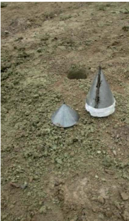
Рис. 3. Общий вид рабочей площадки опытно-промышленного блока (а), конусная металлическая воронка для формирования кумулятивной полости в донной части заряда ВВ (б), зарядание скважин на блоке (в)
