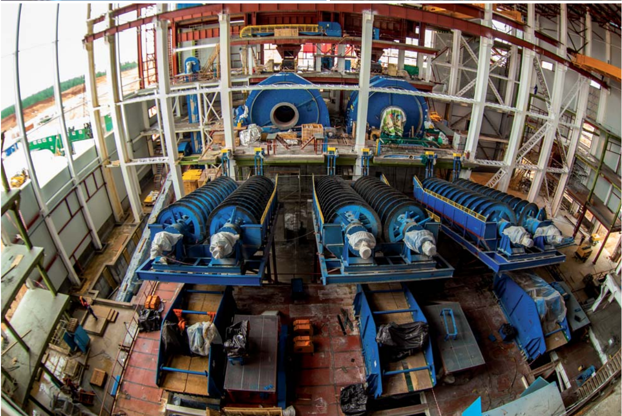
Главный корпус обогатительной фабрики. Спиральные классификаторы
