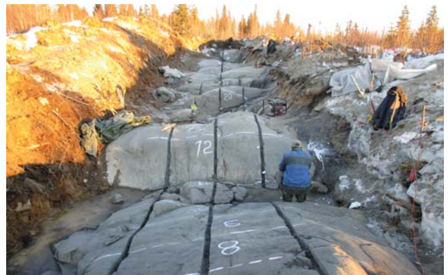
Рис. 2. Борздовое опробование на месторождении Викша
