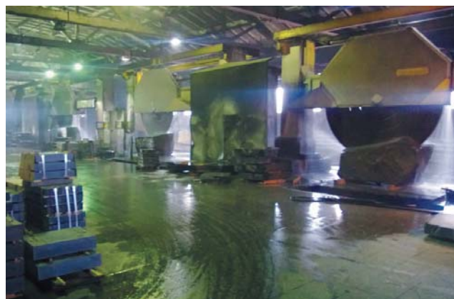
Рис. 4. Ортогональные пилы 3 и 3,5 м итальянского производства компании GMM на камнеобрабатывающем заводе ЗАО «Интеркамень»
