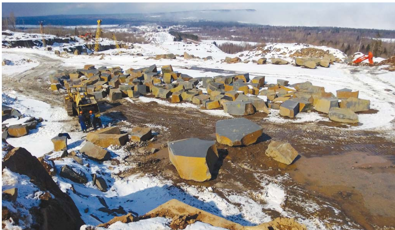
Рис. 2. Отбор блоков на горизонте 120 м карьера «Другорецкое-3»
