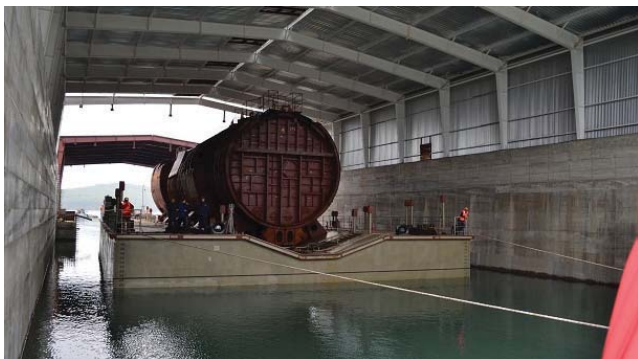
Транспортирование аварийных отсеков АПЛ на специальном понтоне в укрытие
