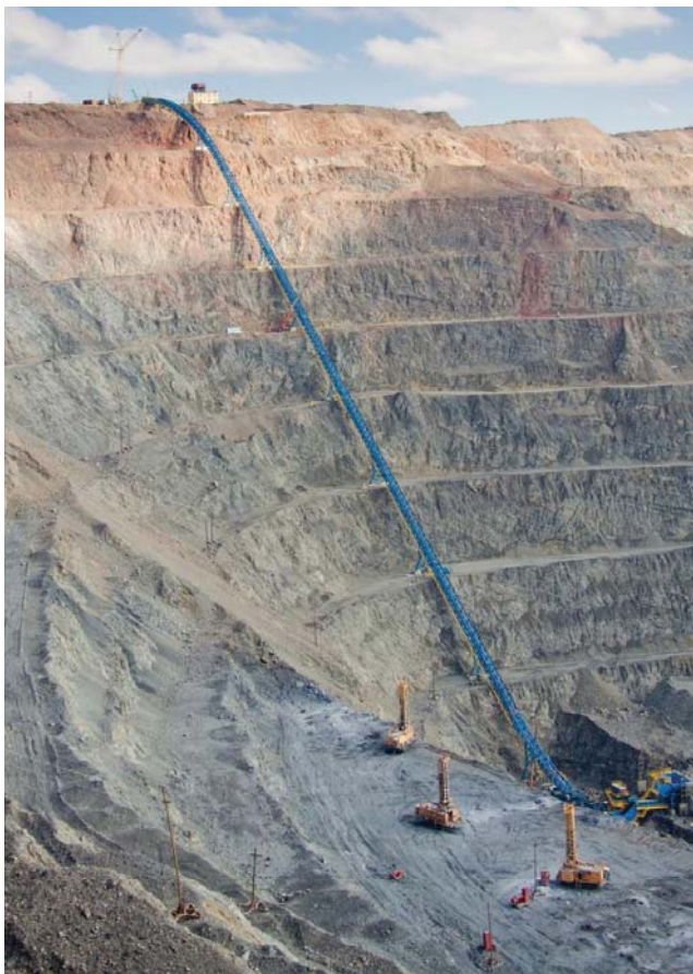
Рис. 5. Крутонаклонный конвейер на борту карьера «Мурунтау»
