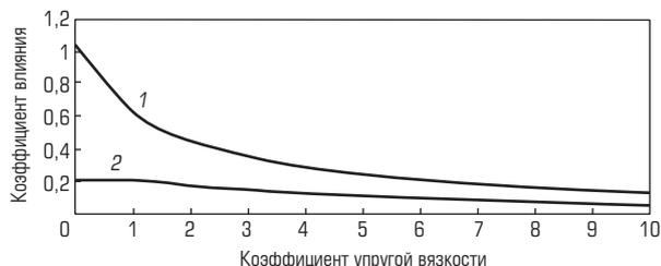
**Рис. 4. Зависимость коэффициентов влияния тектонических деформаций  $k_1$  (1) и  $k_2$  (2) от коэффициента упругой вязкости при  $\nu = 0,2$**
