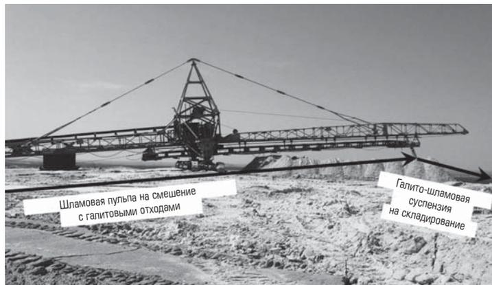
Рис. 1. Приготовление пульпы гидронамыва на откосе солеотвала
