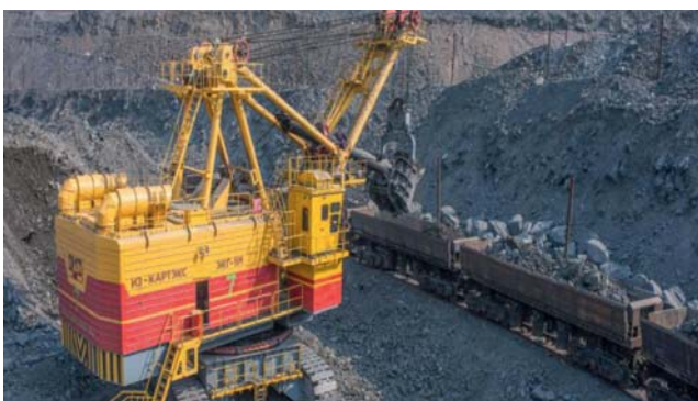
Перегрузка горной массы экскаватором ЭКГ-15М в думпкары ВС-105
