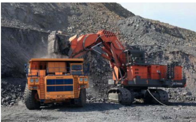
Погрузка руды экскаватором Hitachi EX-5600 в самосвал БЕЛАЗ
