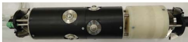
Рис. 10. Трехкомпонентный деформационный датчик ДД-3.1
