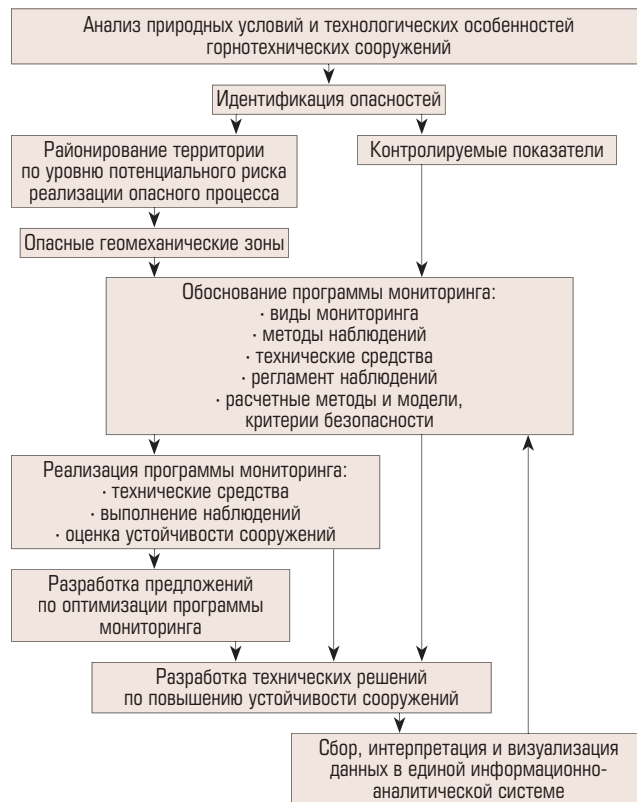
Схема организации геомеханического мониторинга устойчивости горнотехнических сооружений
