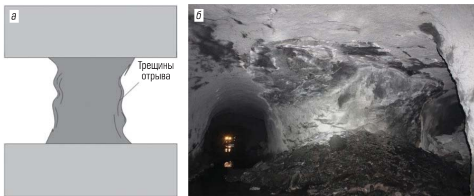
Рис. 1. Типовая форма потери целиком устойчивости [14, 18–20] (а) и иллюстрация локальной потери целиком устойчивости (б)
