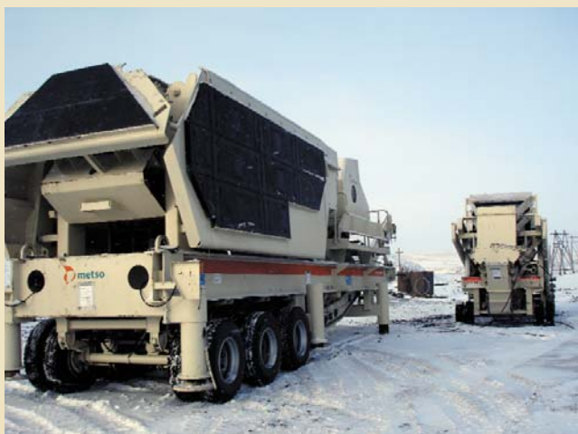
Дробилка и грохот нового дробильного комплекса по переработке угля перед монтажом
