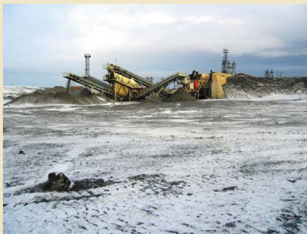
Дробильно-сортировочный комплекс по переработке песчаника фирмы «Метсо Минералз»
