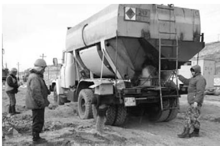
Модernизированная машина МЗ-3Б на зарядке скважин в разрезе «Богатырь»
