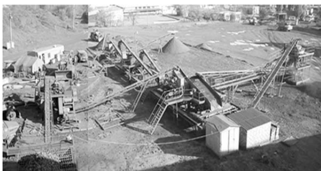
Рис. 2. Технологический комплекс сухой магнитной сепарации с предварительным избирательным дроблением
