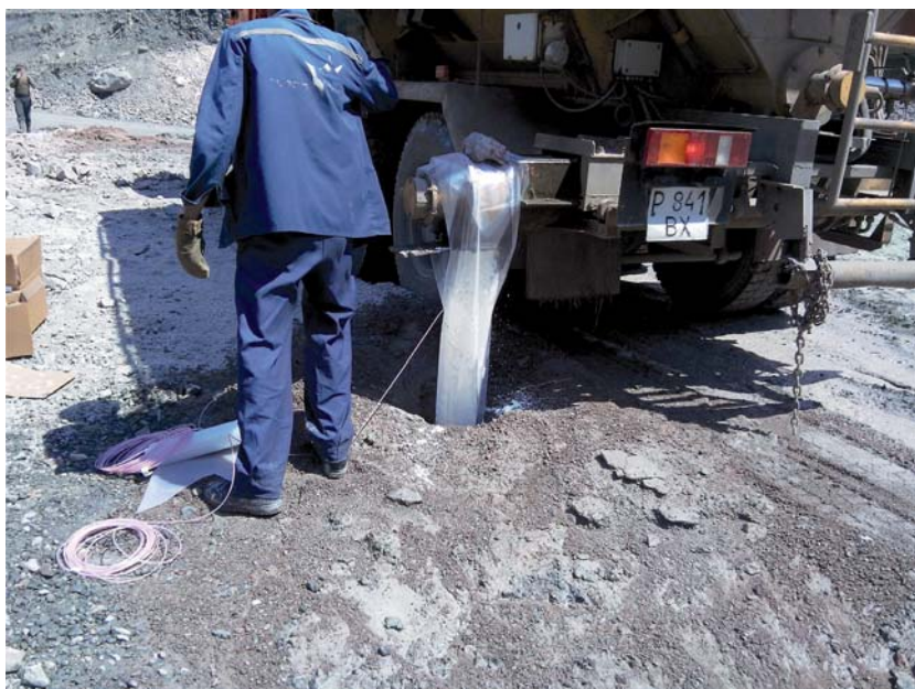
Заряжание скважин гранулитом Э
