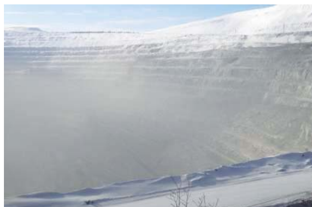
Рис. 1. Пример загазованности в результате образования инверсии радиационного выхолаживания (карьер «Железный», АО «Ковдорский ГОК»)
