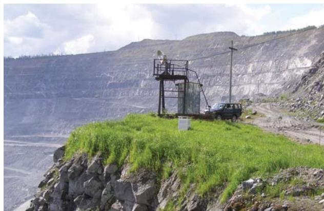
Рис. 5. Мониторинг температурного режима воздуха на бермах карьера «Железный» (гор. +190 м)
