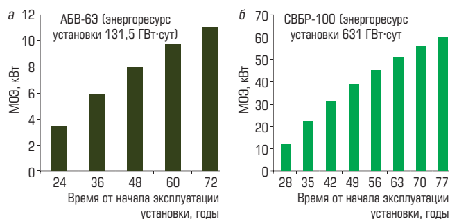
Рис. 3. Динамика мощности остаточного энергосвечения в контейнерном хранилище ОЯТ реакторных установок АБВ-63 (а) и СВБР-100 (б)
