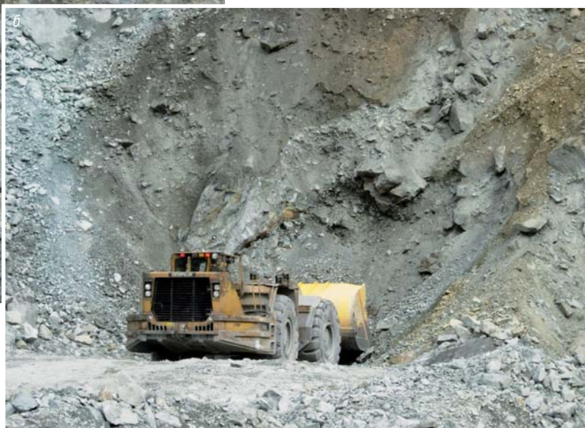
Отбойка временного рудного целика на выброс в карьерное пространство (а) и работа ПДМ Caterpillar R2900G с системой дистанционного управления на отгрузке «выброса» (б)
