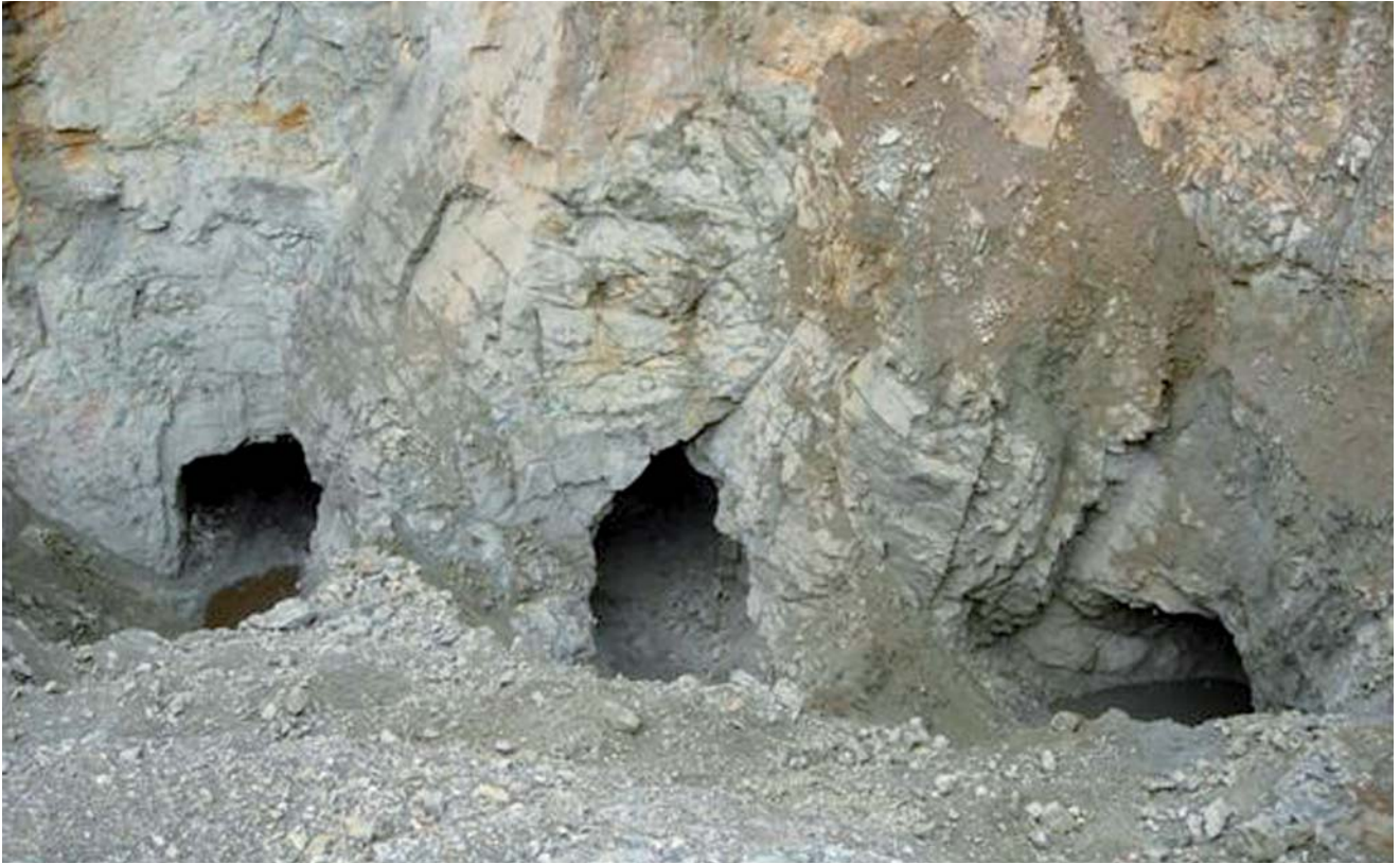
Камера опытного участка по окончании выемки придонных запасов руды
