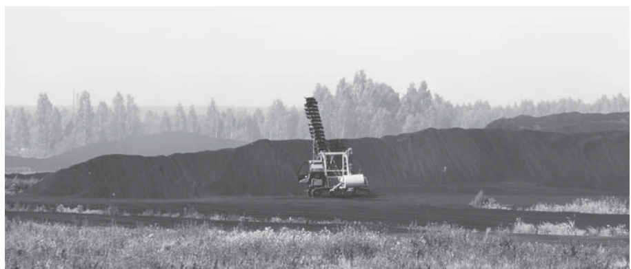
Формирование укрупненного штабеля фрезерного торфа машиной МТФ-71 «Амкадор»
