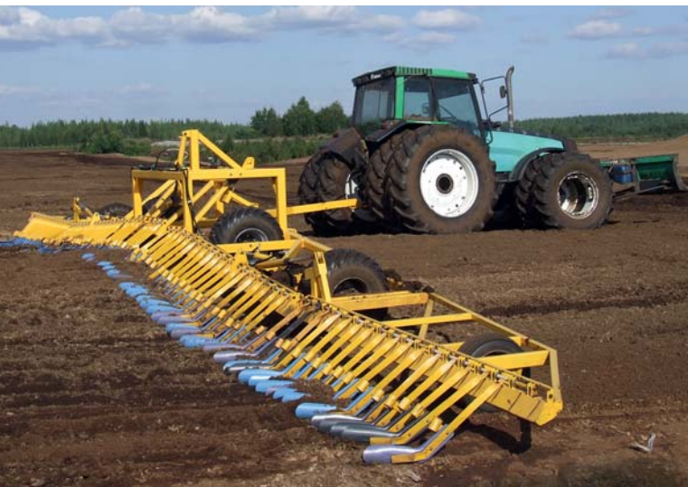
Ворошилки финского производства для интенсификации процесса полевой сушки торфа
